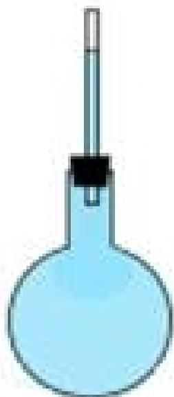
Возьмём колбу с водой и заткнём её пробкой с тонкой трубкой. Если теперь нагревать воду, то за счёт расширения воды, её уровень в трубке будет повышаться. По уровню поднятия воды в трубке можно сделать вывод об изменении температуры.
